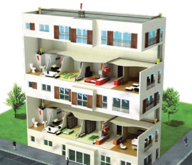
▲ VMC a flusso singolo Autoregolabile o Igroregolabile su impianto collettivo.
